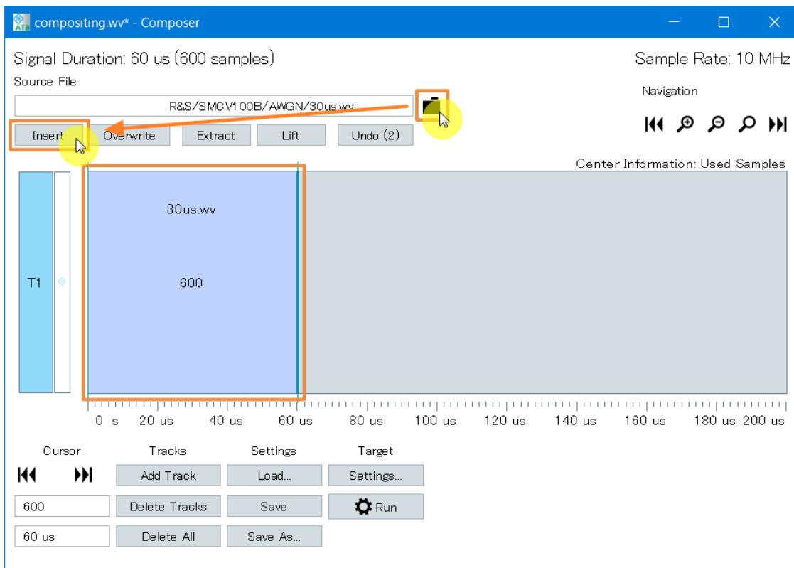
挿入したいファイルを選択して【Insert】ボタンをクリックすると波形が作成されます。
