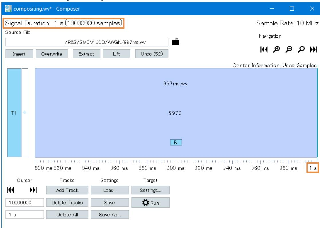
Blank 波形は Pulse 波形作成で Width=0s として作成します。
