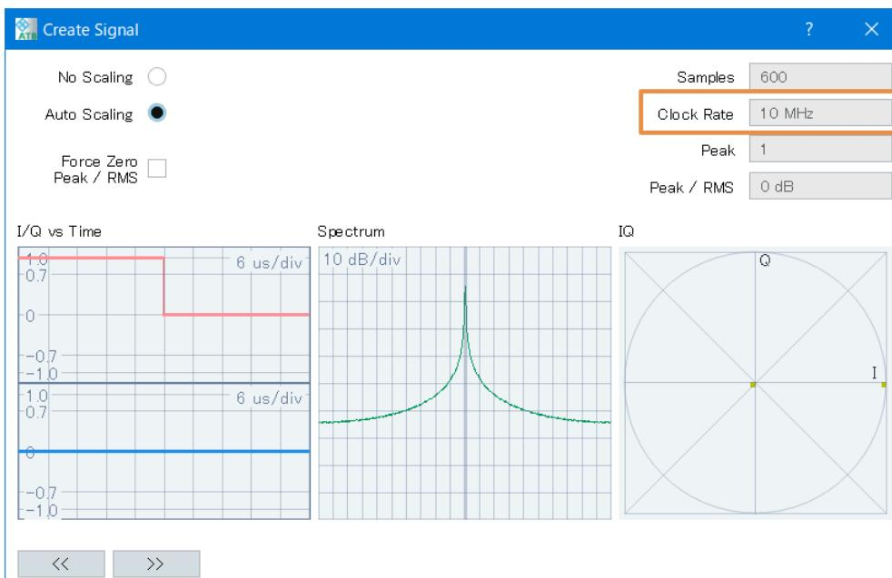
なるべく Clock Rate が 10MHz 以下になるように Resolution を調整します。
