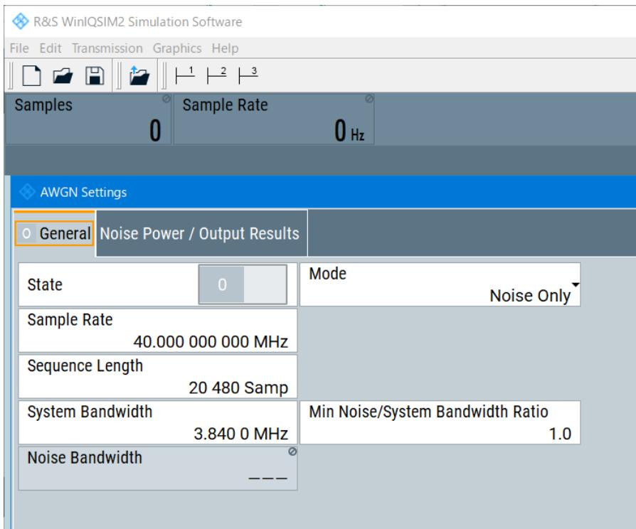
【Sample Rate】は【System Bandwidth】の 1.25 倍に設定します。
