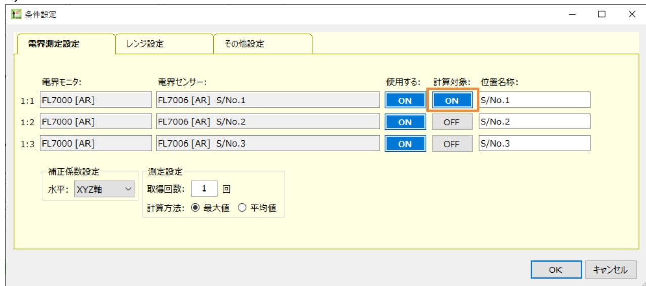
b) にてキャリブレーションを行う際はメイン画面にて電界センサーを指定して実行します。
