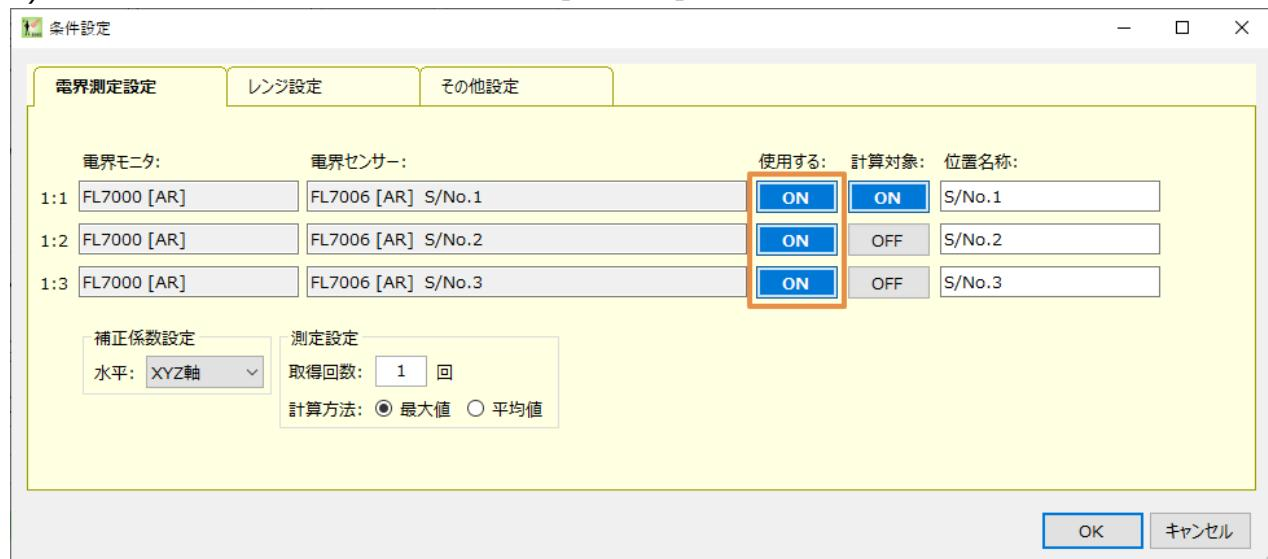
b) 行う際は使用する電界センサーにチェックを入れ、位置を指定して実行します。
